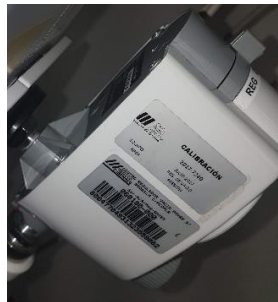
Fig. 50. Marcación reguladores de vacío. Tomado de [107].
